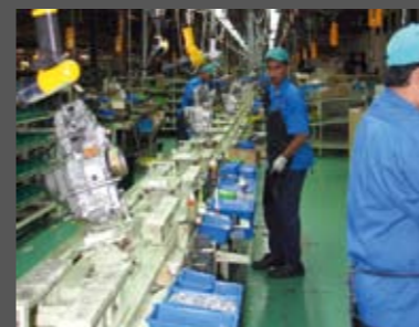
Γραμμή συναρμολόγησης κινητήρα. Ο κάθε εργαζόμενος έχει στη διάθεσή του συγκεκριμένο χρόνο και χώρο. Οι βάσεις όπου τοποθετούνται οι κινητήρες, αφού "κλείσουν" τα κάρτερ, έχουν τρισδιάστατη δυνατότητα κίνησης, διευκολύνοντας απίστευτα τη διαδικασία της συναρμολόγησης
