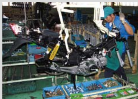
Βρισκόμαστε στην τελική γραμμή παραγωγής. Πρώτα τοποθετούνται η πλεξούδα και το κεντρικό στάντ. Αμέσως μετά ο κινητήρας και στη συνέχεια οι αναρτήσεις, οι τροχοί, το τιμόνι, τα περιφερειακά και τα πλαστικά. Εξαιρετικά ενδιαφέρουσα είναι η διαδικασία τοποθέτησης των ρουλεμάν του λαδιού. Σε δεύτερο πλάνο διακρίνονται οι "χύμα" μπιλίτες. Με τη βοήθεια ενός μαγνήτη και αρκετού γράσου, με ελάχιστες κινήσεις τοποθετούνται στη θέση τους
