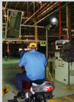
Έλεγχος κύλισης, οπτικός έλεγχος και δυναμόμετρηση. Οι τροχοί περνούν διαδοχικά πάνω από το τύμπανο και ελέγχονται η ευστάθεια του μπροστινού συστήματος, τα φρένα και βέβαια η απόδοση του κινητήρα. Ταυτόχρονα, γίνεται και έλεγχος σε όλες τις λυχνίες και στην κόρνα. Ο ανεμιστήρας και οι καθρέφτες δεν είναι διακοσμικά στοιχεία...
