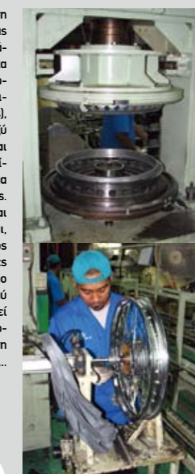
Βρισκόμαστε στην τελική γραμμή παραγωγής. Πρώτα τοποθετούνται η πλεξούδα και το κεντρικό στάντ. Αμέσως μετά ο κινητήρας και στη συνέχεια οι αναρτήσεις, οι τροχοί, το τιμόνι, τα περιφερειακά και τα πλαστικά. Εξαιρετικά ενδιαφέρουσα είναι η διαδικασία τοποθέτησης των ρουλεμάν του λαδιού. Σε δεύτερο πλάνο διακρίνονται οι "χύμα" μπιλίτες. Με τη βοήθεια ενός μαγνήτη και αρκετού γράσου, με ελάχιστες κινήσεις τοποθετούνται στη θέση τους
