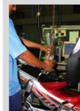
Αφού όλα τα στάδια ολοκληρωθούν, προστίθεται λίγο καύσιμο και το κάθε παπί οδηγείται στο δυναμόμετρο
