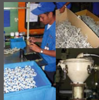
Εδώ κατασκευάζονται τα πλαστικά εξαρτήματα του κινητήρα, και στη συγκεκριμένη φάση, το πλαστικό γρανάτζι της τράμπας λαδιού. Το πρωτογενές υλικό είναι σε στεγνή μορφή. Το περίεσομα, και τα καλούπια, ξαναχρησιμοποιούνται. Ο τεχνικός τοποθετεί τον μεταλλικό άξονα στο κέντρο του γραναζιού
